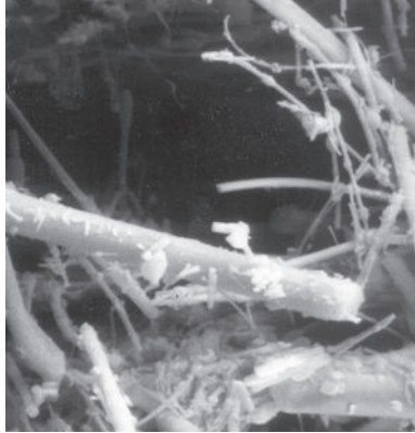
Makroaufnahme der Filterfläche mit angelagerten Schadstoffen
