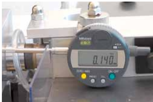
µ-genaue Probenzustellung mit Digital-Mikrometer
