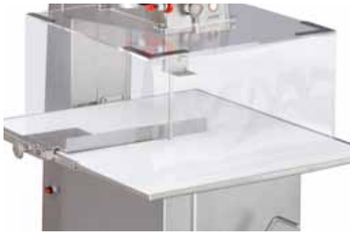
Großer Arbeitsbereich mit Spritzschutz und Parallelanschlag
