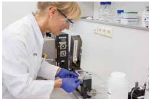
Kleben der Probe auf den Objektträger
