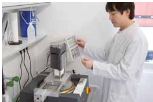
Scheifen des Dünnschliffes
