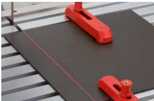
EXAKT 311 – Zuschnitt von CFK Streifen für Zugversuch
