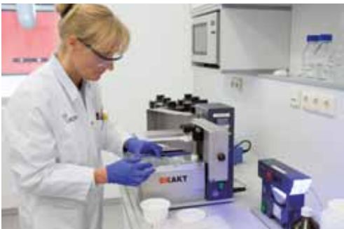
Einbetten von fixierten Proben
