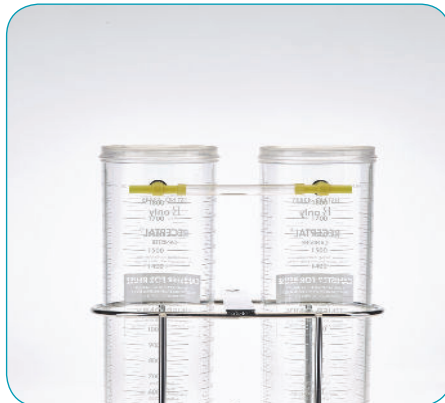
2. T-Stücke der Behälter mit dem Vakuumschlauch verbinden.
